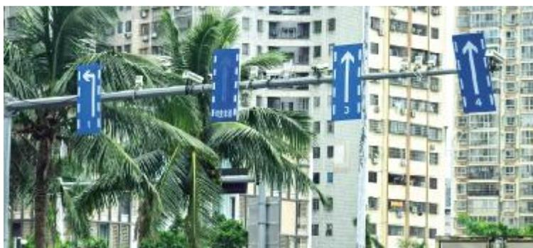
10月14日上午,记者来到龙昆南路与南海大道交叉口看到,该路口北向南方向处新增四块车道导向指示牌,道路左侧第二条车道指示牌是块电子“可变车道”标牌,可由指挥中心控制改变该车道的行驶方向。
